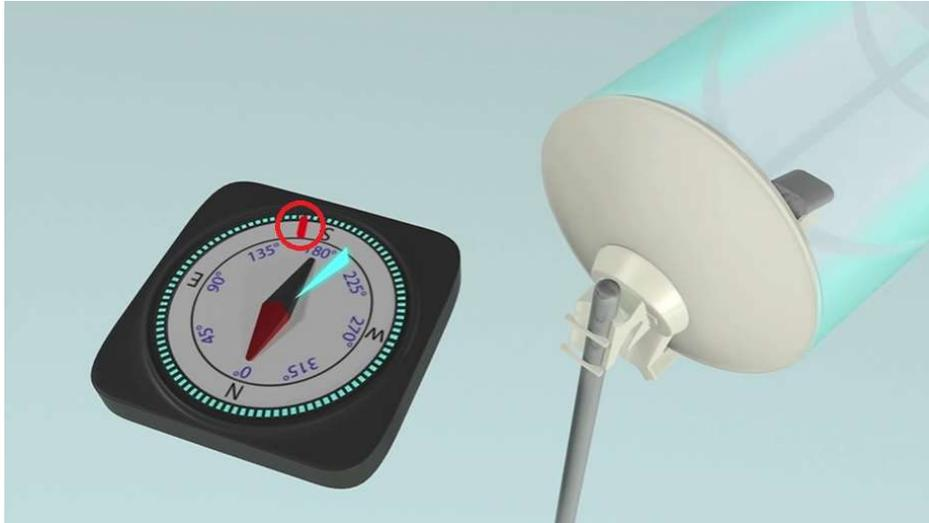
Prüfen Sie die Signalstärke bis Sie 10db oder mehr erreichen. Ziehen Sie die Schrauben fest an.
