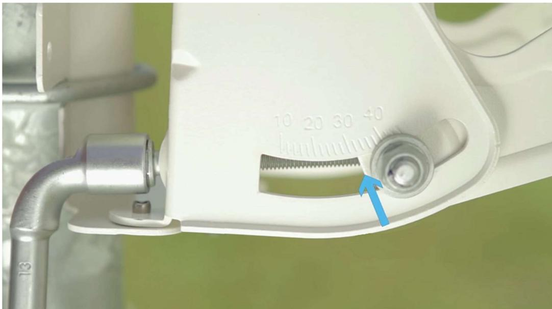
Nach Einstellung der Elevation, bewegen Sie die Schüssel Richtung Azimuth-Ergebnisse bis Sie schneller und starker Beeps hören. Bewegen Sie die Schüssel in dieser Richtung bis Sie einen starken Ton erhalten. Zu diesem Punkt haben Sie das Signal erreicht.
